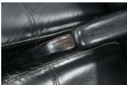
Partes metálicas gastas
