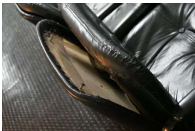
Descolamento do estofado
